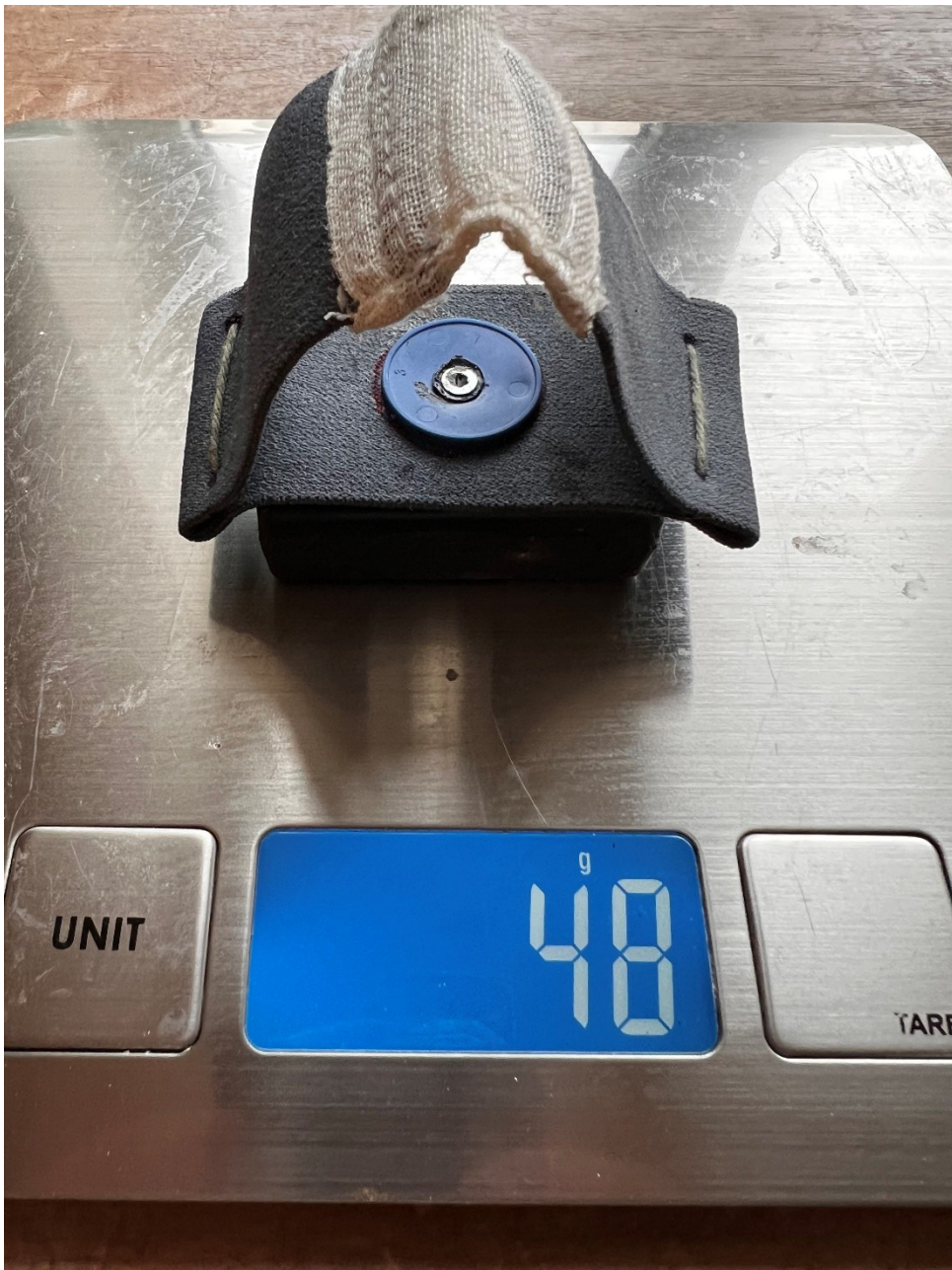
Figur 5 Samlet vægt for GPS-halsbåndet blev 48 gram, svarende til 3,2% af et nyfødt rådyrlams vægt.
