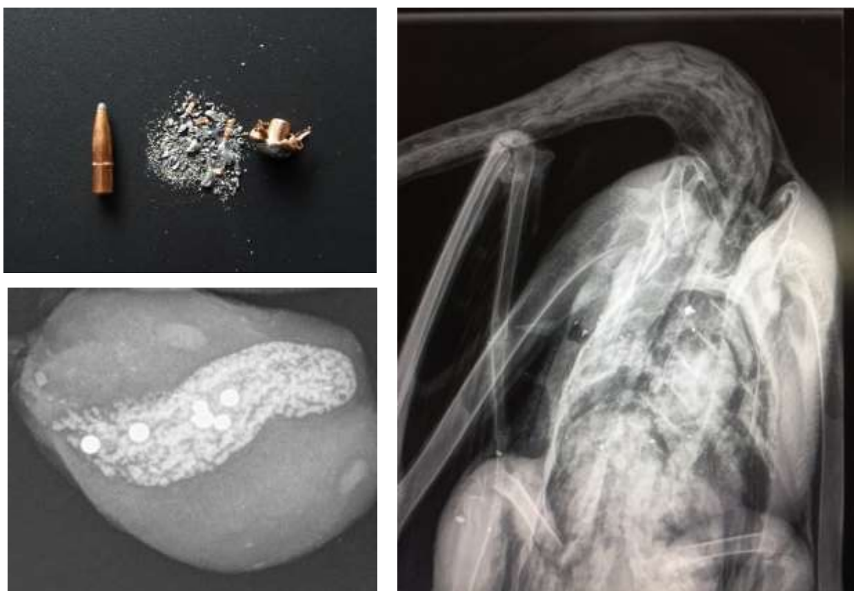
Figur 1. Øverst til venstre: Riffelprojektiler af bly splintres ved gennemtrængning af byttet. Hermed frigives en stor mængde blyfragmenter med risiko for forgiftning af ådselædere og andre konsumenter. Billedet viser et almindeligt blyprojektil før og efter træf. Til højre: Fordeling af projektilfragmenter i knopsvane skudt med bly-riffelammunion. Nederst til venstre: Fasankråse med 6 ædte hagl, heraf 4 stål- og 2 blyhagl.
